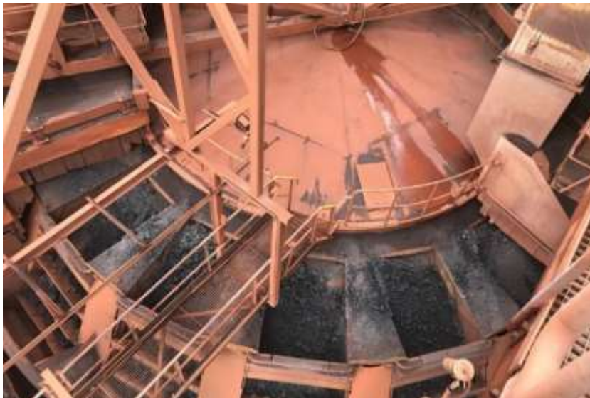
Figuur 4.7 Een sinterkoeler (bron: Tata Steel)
